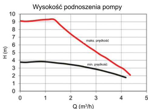
Dostępne zewnętrzne ciśnienie statyczne VS Natężenie przepływu
